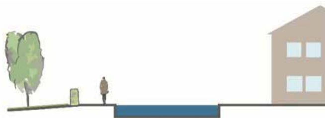
Exempel på säkrad avrinningsväg då ledningsnätet är fullt*
