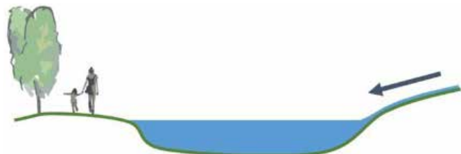
Avledning till plats där vattnet inte gör skada, i en park eller ett grönråk med lågpunkt*
